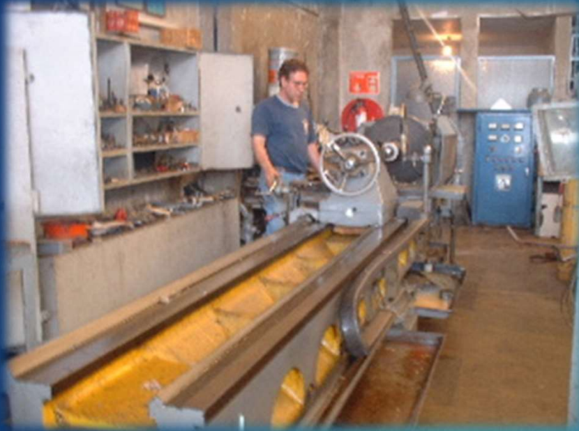
Torno de 600 mm de diámetro de volteo por 3.0 mts de bancada.
